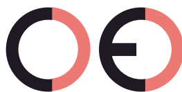
Faux marquage CE (trop éloigné)
